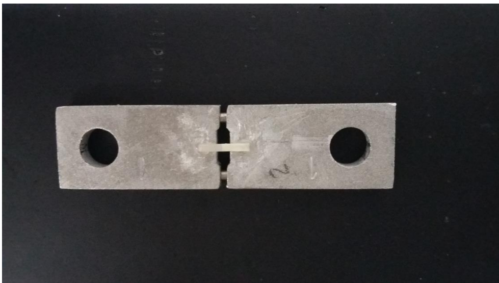
Figura 25. Interface adesiva do palito entre os dois lados da garra, protegida da ação da cola.
