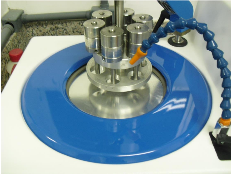
Figura 2. Politriz universal utilizada por 5 segundos para padronização da smear layer. Foi utilizada nela uma lixa de carbeto de silício de granulação #600 sob irrigação constante.
