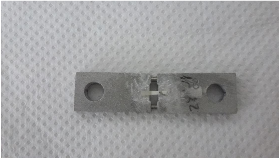
Figura 31. Palito rompido – Falha coesiva em dentina.
