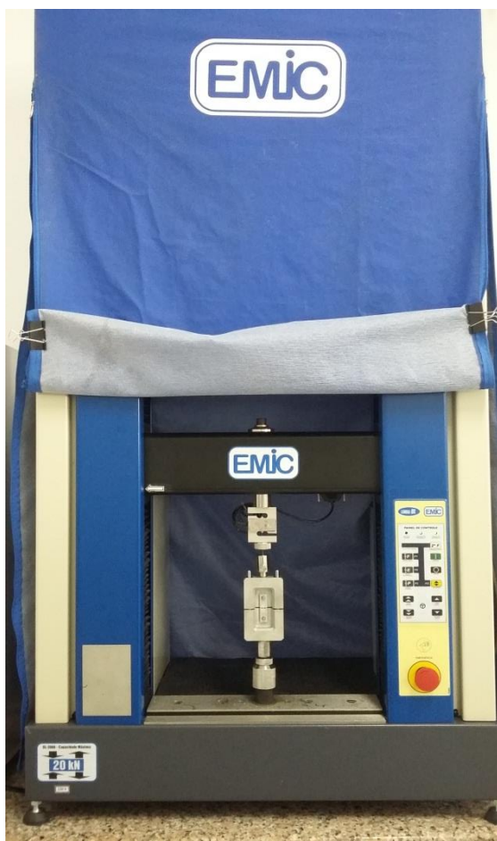
Figura 27. Máquina universal de ensaios (EMIC DL 2000, São José dos Pinhais, PR, BR).
