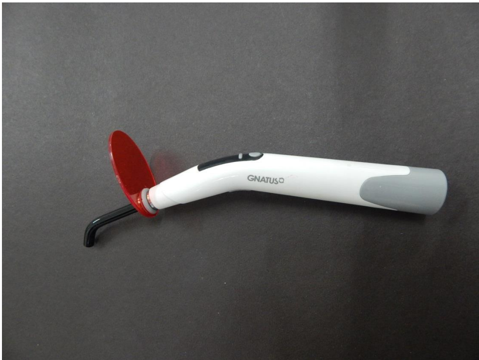
Figura 10. Fonte de luz led de alta potência ( 1200 \text{ Mw/cm}^2 – Gnatus, Ribeirão Preto, São Paulo, BRA).
