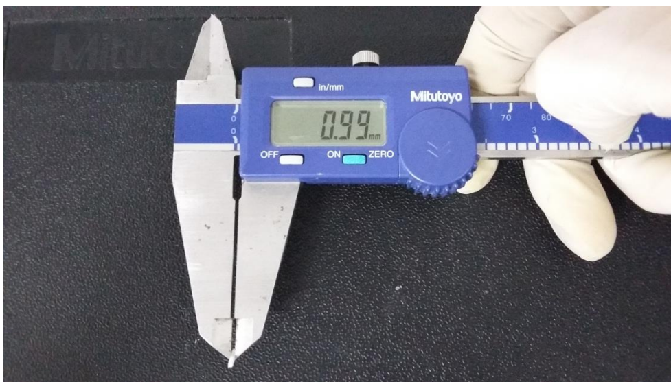
Figura 22. Medição do palito sendo realizada por paquímetro (Mitutoyo, Suzano, SP, BR) antes da colagem do mesmo na garra.
