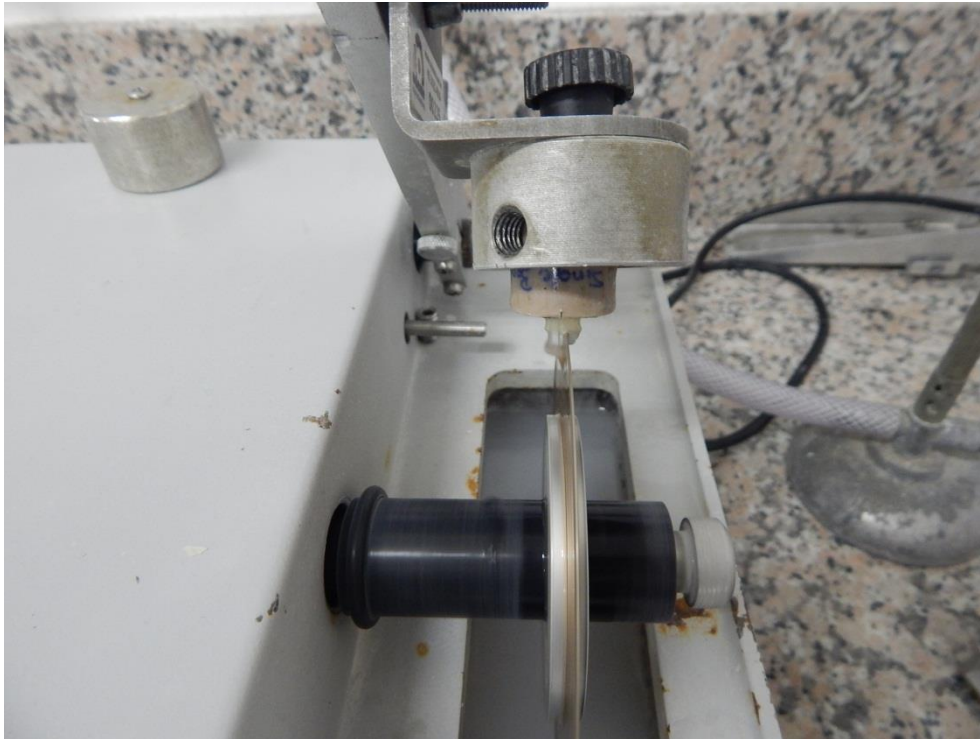
Figura 18. Espécime sendo seccionado no sentido méso-distal com auxílio de um disco diamantado dupla-face de alta granulação (Extec, Enfield, NH, USA)
